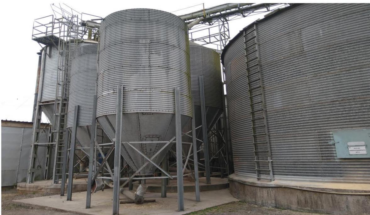
Nesta foto vemos sete dos silos metálicos de armazenamento de cereais. Estando à direita, o silo com fundo chato e aerado com capacidade de 300t. No centro temos os dois silos de 12t. Atrás destes temos mais dois silos de 20t e dois de 18t.
